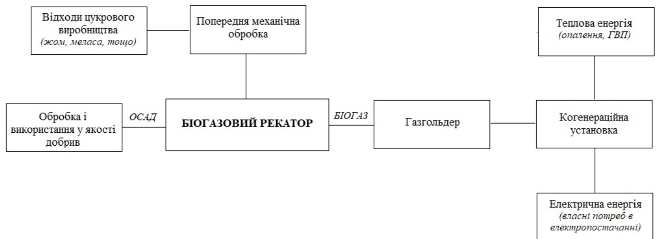
Рисунок 3.2 – Пропонована схема енергетичної утилізації відходів цукрового виробництва
