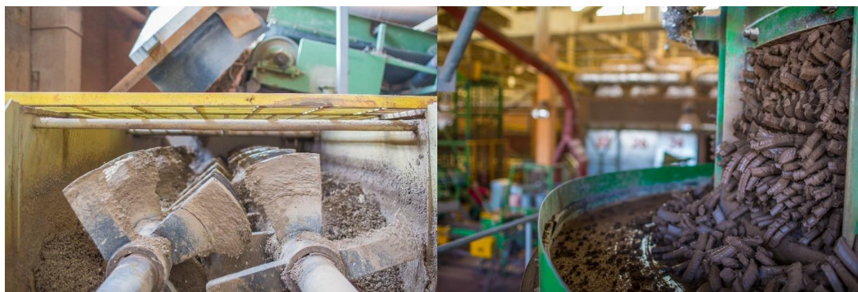
Рисунок 3.3 – Процес отримання глиняних брусків (фото: kerameya.com.ua)
