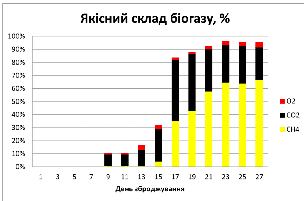
Рисунок 3.5 – Якісний склад біогазу отриманого в процесі сумісного збродження перепелиного посліду та надлишкового активного мулу
