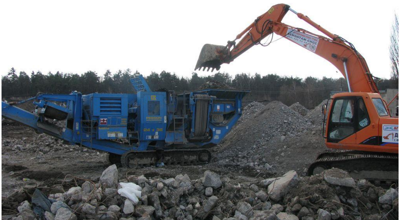
Рисунок 2.2 – Приклад мобільного дробильно-сортувального комплексу (фото: https://apg-ua.org/ )
