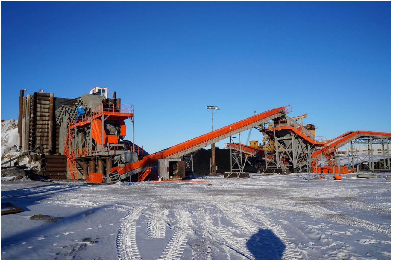
Рисунок 2.1 – Приклад стаціонарного дробильно-сортувального комплексу (фото: https://hydromarket.com.ua/ )
