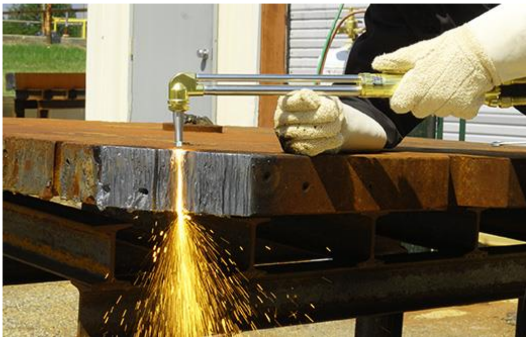
Рисунок 2.7 – Різка металу киснево-газовим різакром (фото: https://stabbing.ru/ )
