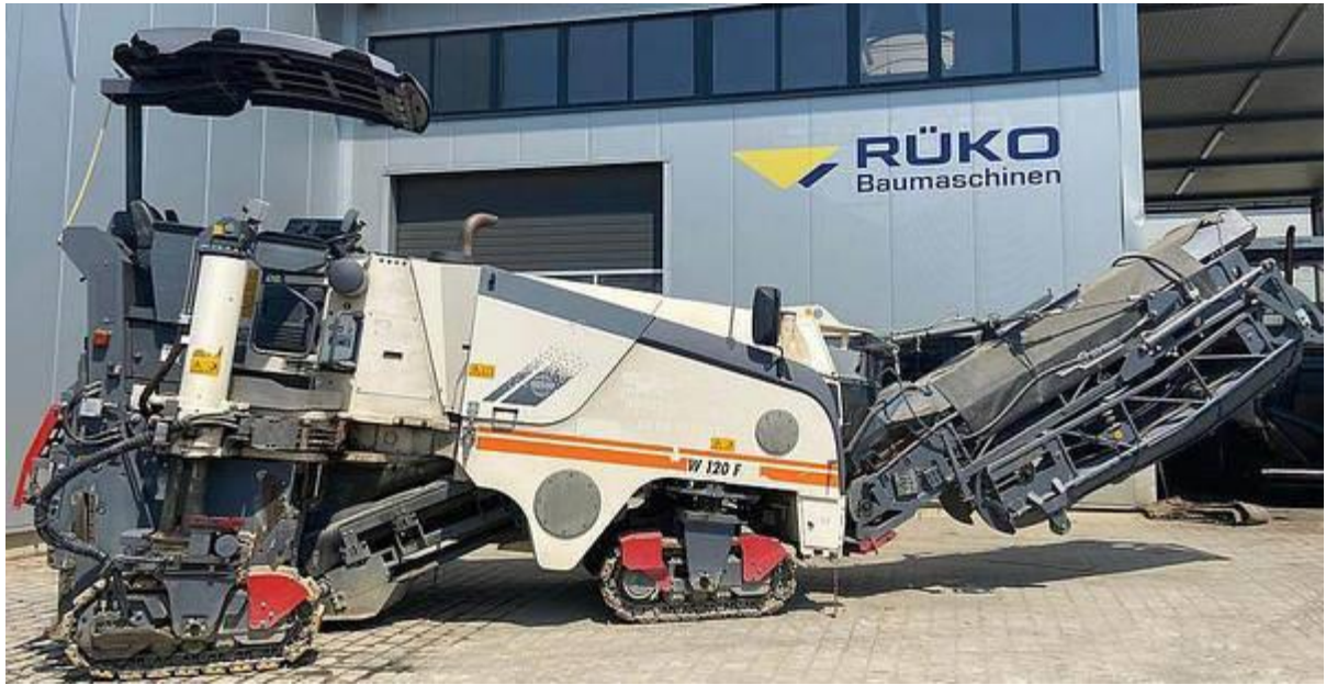
Рисунок 2.3 – Приклад дорожньої фрези для зняття верхнього шару асфальтобетонного покриття (фото: https://hydromarket.com.ua/ )
