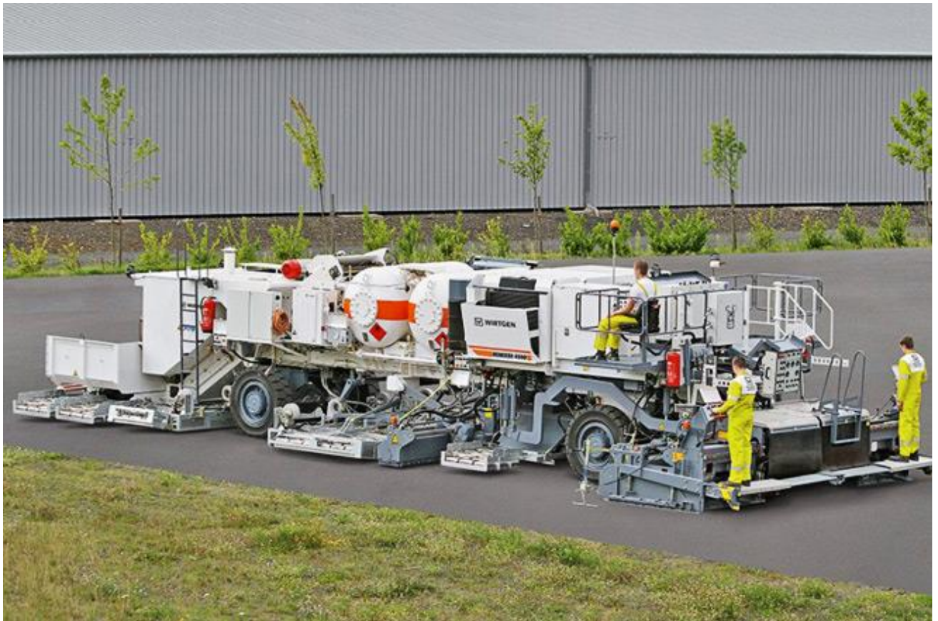
Рисунок 2.5 – Приклад установка горячего ресайклінгу (фото: https://unidorstroy.kiev.ua/ )
