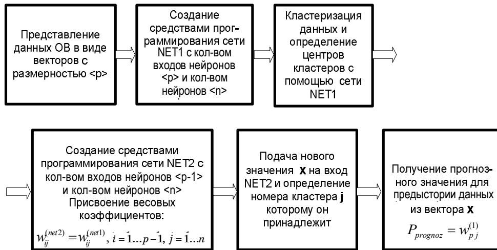
Рисунок 3 - Блок-схема работы программы обучения нейронной сети и прогнозирования электрических нагрузок
