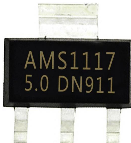
Рисунок 3.5 - Лінійний регулятор напруги AMS1117
