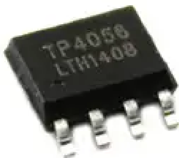
Рисунок 3.7- Контролер заряду Li-Po акумулятора TP4056
