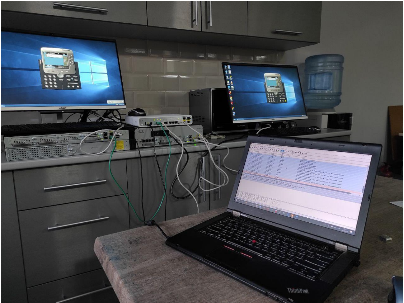
Рисунок 3.17 – Тестування сервісу VoIP у сконфігурованій в автоматичному режимі мережі Ethernet
