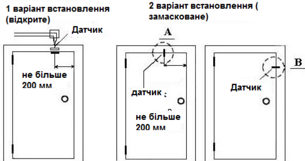
Рисунок 3 – Можливі способи монтажу магнітоконтактних датчиків
