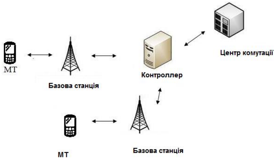
Рисунок 6 – Схема роботи GSM мережі
