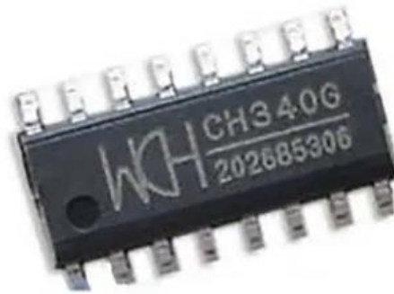
Рисунок 5.4 – Мікросхема CH340G в корпусі SOP-16
