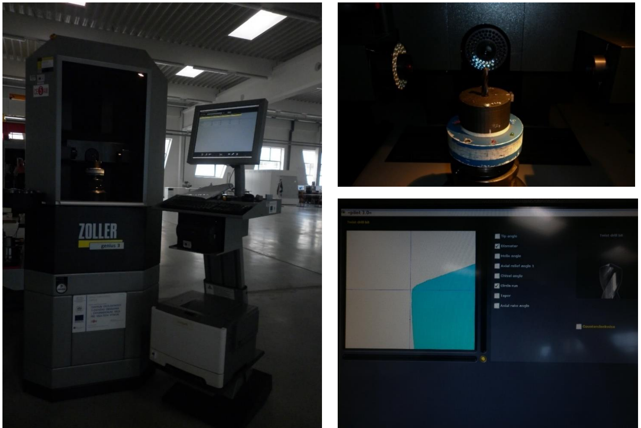
Рисунок 2.1 – Вимірювання геометричних параметрів свердла
