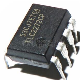
Рисунок 2.6 – Призначення виводів та зовнішній вигляд мікросхеми TLC2272
