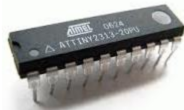
Рисунок 2.4 – Призначення виводів та зовнішній вигляд мікроконтролера ATTINY 2313
