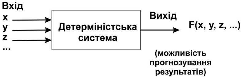
Рисунок 6.2 – Функціональна схема детерміністської системи
