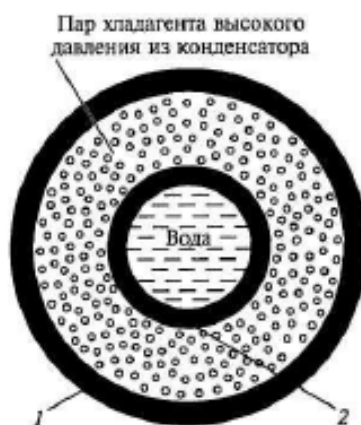
Рисунок 1.6 – Поперечний переріз конденсатора типу «труба в трубі»:
