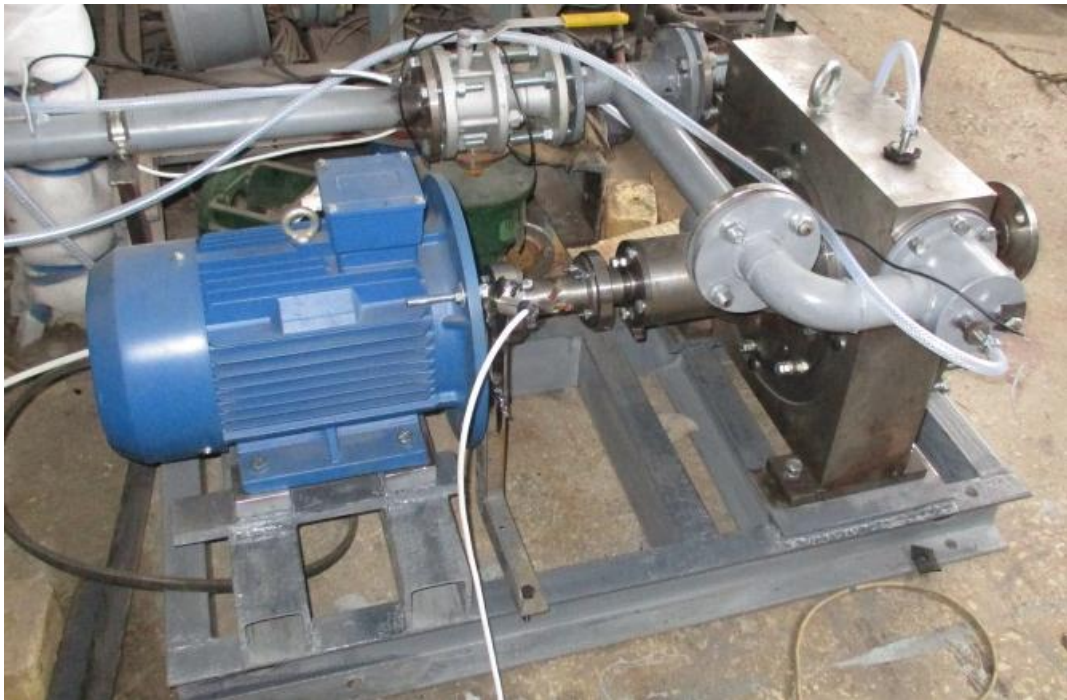
Рисунок 1.2 – Турбогенератор на базі вихрової розширювальної машини [8]
