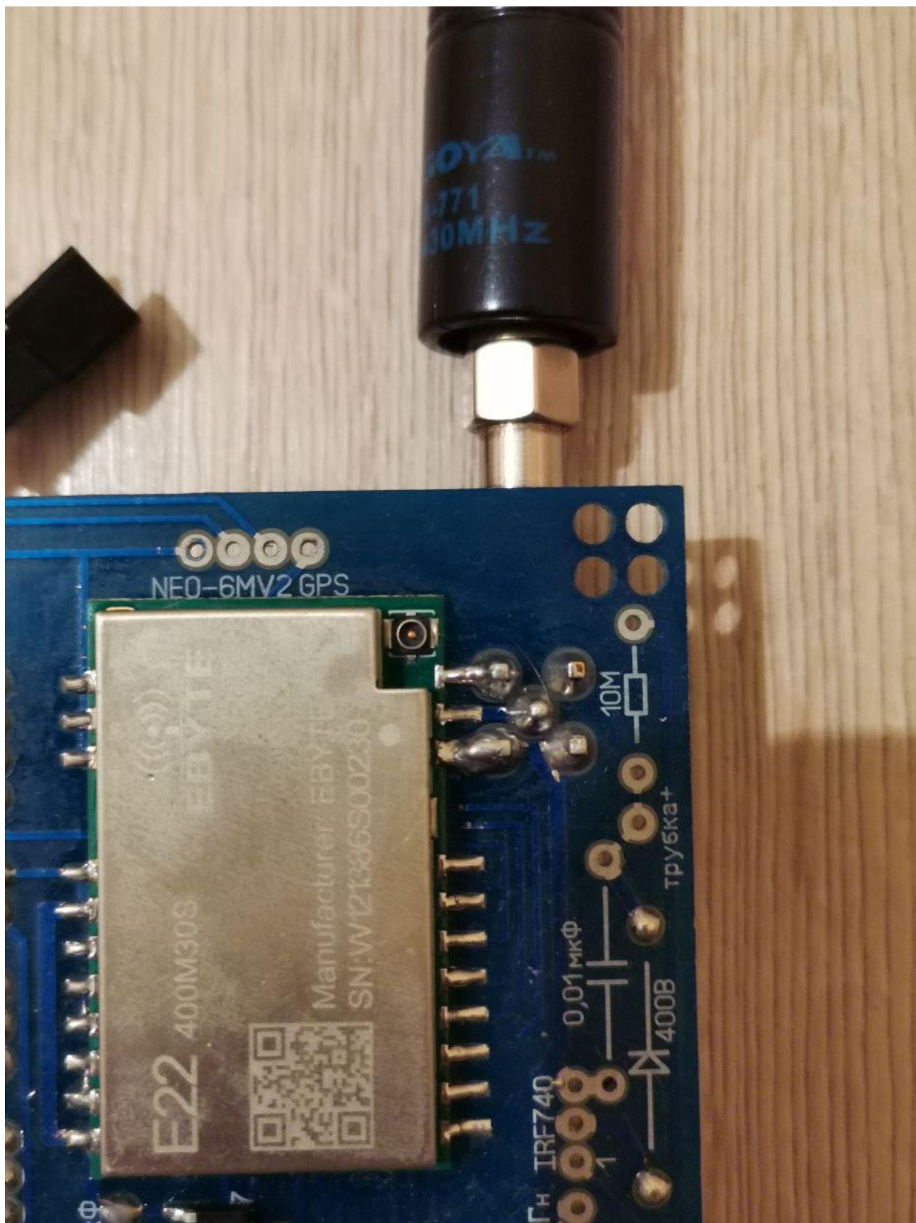
Рисунок 3.7 – Запаяна LoRa й антена біля неї.
