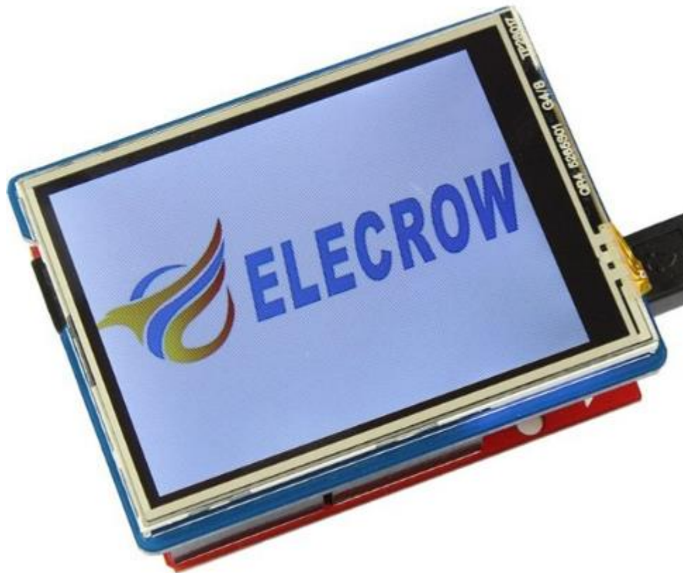
Рисунок 3.8 – ELECROW 2.8 TFT Touch Shield v4.3 [5].
