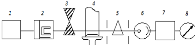
Рисунок 7.1 – Принципова схема атомно-абсорбційного спектрометра: 1 – живлення джерела; 2 – джерело випромінювання; 3 – модулятор; 4 – атомізатор; 5 – монохроматор; 6 – детектор; 7 – підсилювач; 8 – відліковий пристрій
