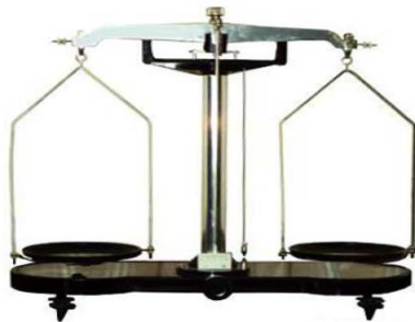
Рисунок 3.3 – Ваги аналітичні механічні
