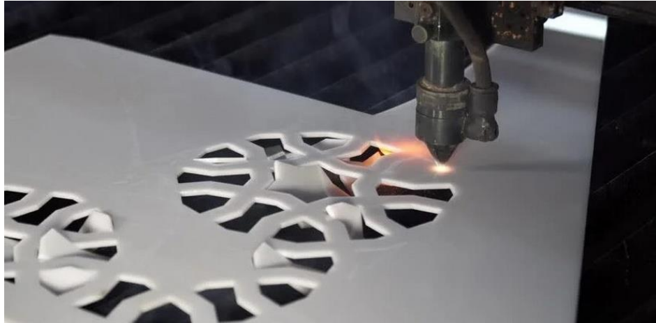
Рисунок 2.8 – Приклад порізки ABS-пластику на лазерному гравірувальному верстаті [29]
