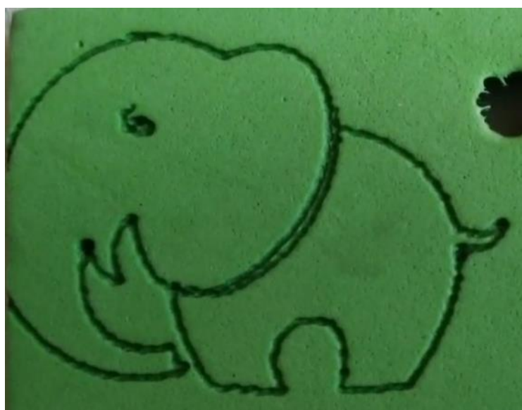
Рисунок 3.14 – Оброблення матеріалу EVA з опцією Line: Outline
