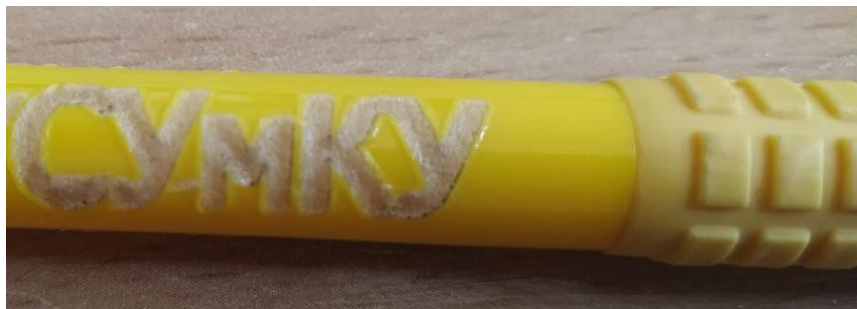
Рисунок 3.20 – Оброблення матеріалу на основі пластику з рекомендованими режимами
