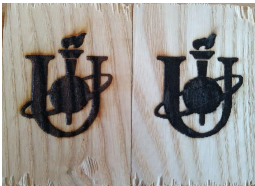
Рисунок 3.8 – Порівняння двох однакових зображень з варіюванням швидкості оброблення лазером
