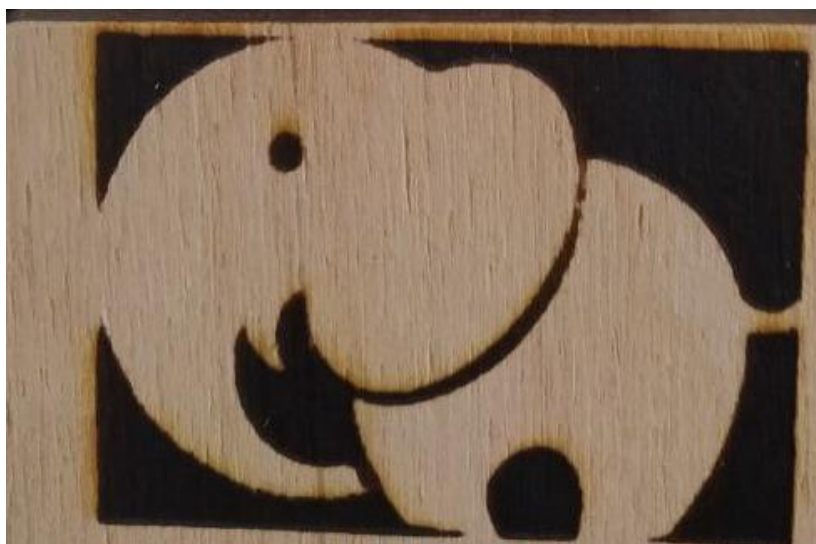
Рисунок 3.10 – Приклад оброблення лазерним гравірувальним верстатом при оптимальних режимах різання
