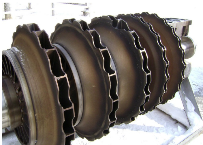
Рисунок 3.2 - Ротор ЗПЧ-294ГЦ2-750/7-21 та фрагменти пошкодженого колеса 3-го ступеня
