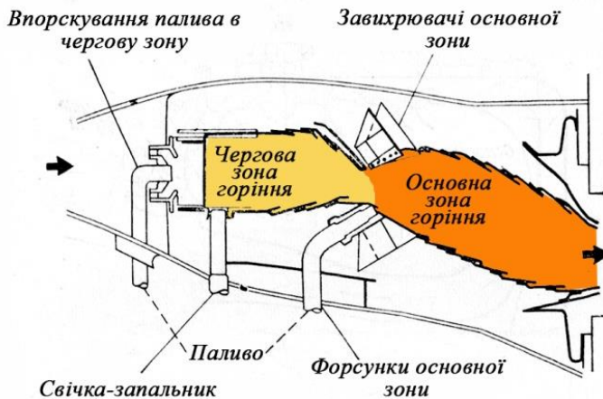
Рисунок 16.41 – Двоюресна камера згоряння
