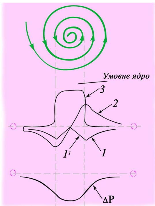
Рисунок 16.15 – Модель енергії від обертального руху до руху в осьовому напрямку
