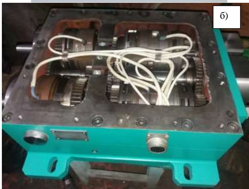
Рисунок А.3 – Кулькова гвинтова передача (а) та конструктивні елементи АКШ (б)
