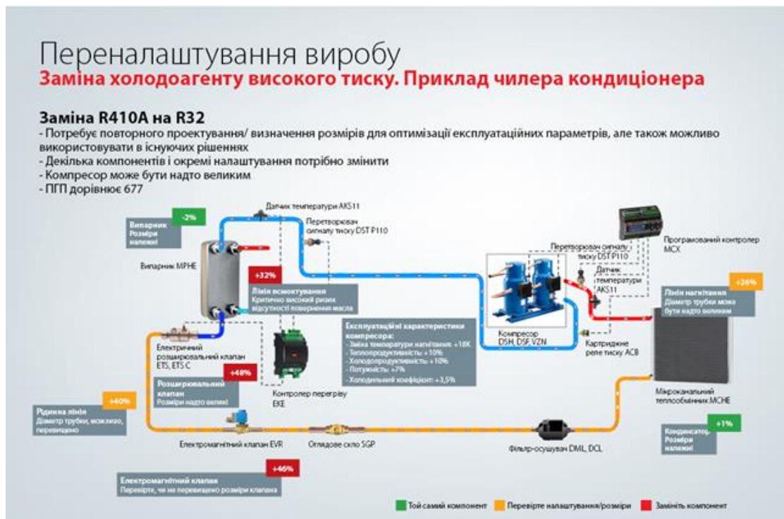
Рисунок 2 – Приклад заміни R410A на R32
