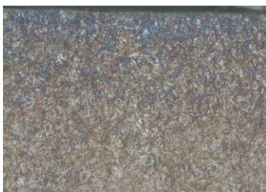
Рисунок 5.2 – Мікроструктура нітроцементованої сталі 25ХГТ (x200)
