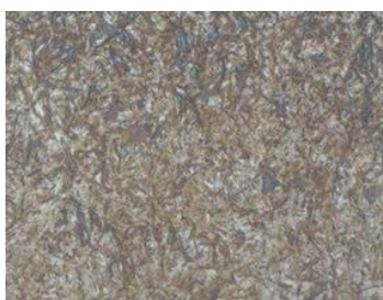
Рисунок 5.3 – Мікроструктура основи сталі 25ХГТ після відпуску (x200)
