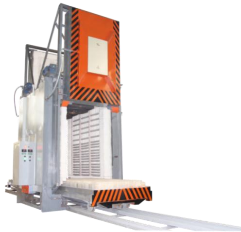
Рисунок 5.4 – Електрична камерна піч типу СДО 8.16.8/11,5
