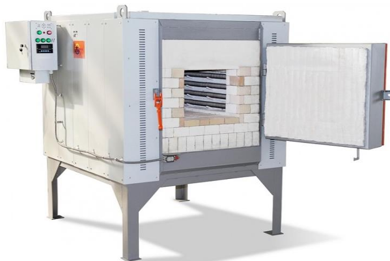
Рисунок 5.5 – Камерна електротермічна піч СНО-4.8.3/12,5 [26-28]
