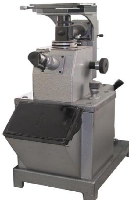
Рисунок 3.1 – Зовнішній вигляд мікроскопа МИМ – 7 [12, 21]
