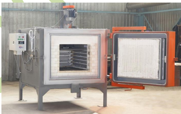
Рисунок 5.6 – Камерна електротермічна піч СНО-6.10.4/7,5 [27-29]
