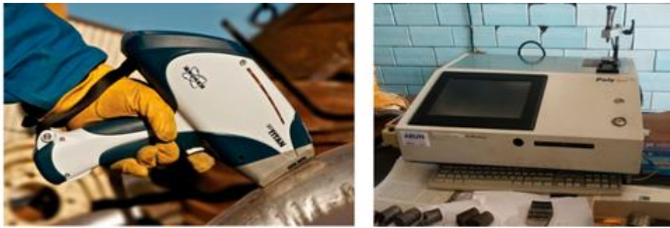
Рисунок 4.4 – Прибори для визначення хімічного складу сталі: аналізатор рентгенофлуоресцентний (портативний) S1 TITAN SMX 524 (а) та спектрометр (стаціонарний) оптичний емісійний PolySpek Junior (б) [13]
