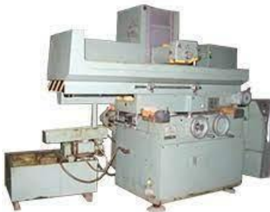
Рисунок 1.1 – «Плоскошліфувальний верстат 3Е711В»
