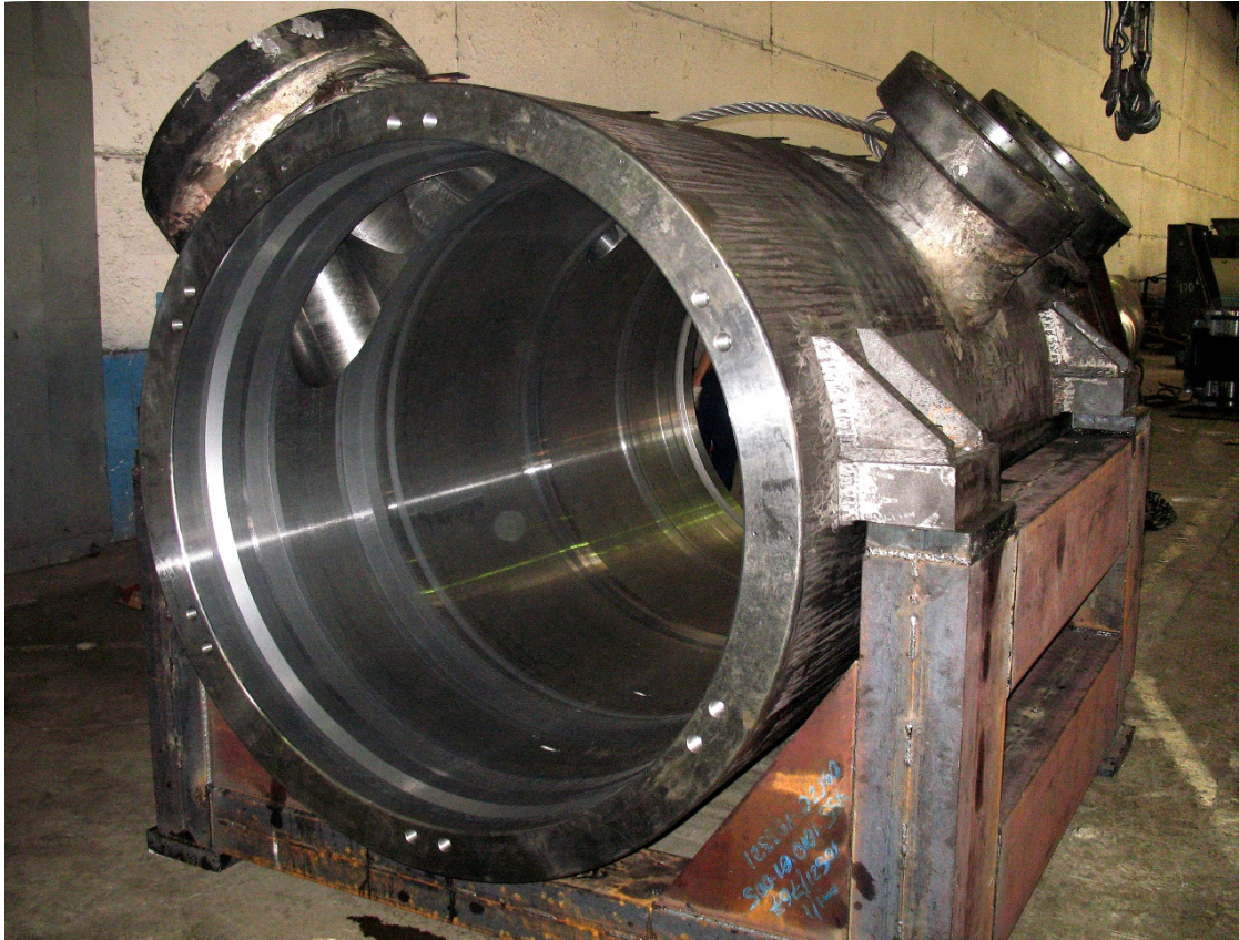
Рис 1.4 – Корпус відцентрового компресора С325ГЦ2-650/6-56М12 КС Газлі
