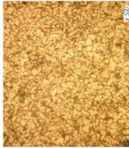
Структура сталі 45 (сорбіт) x 500
