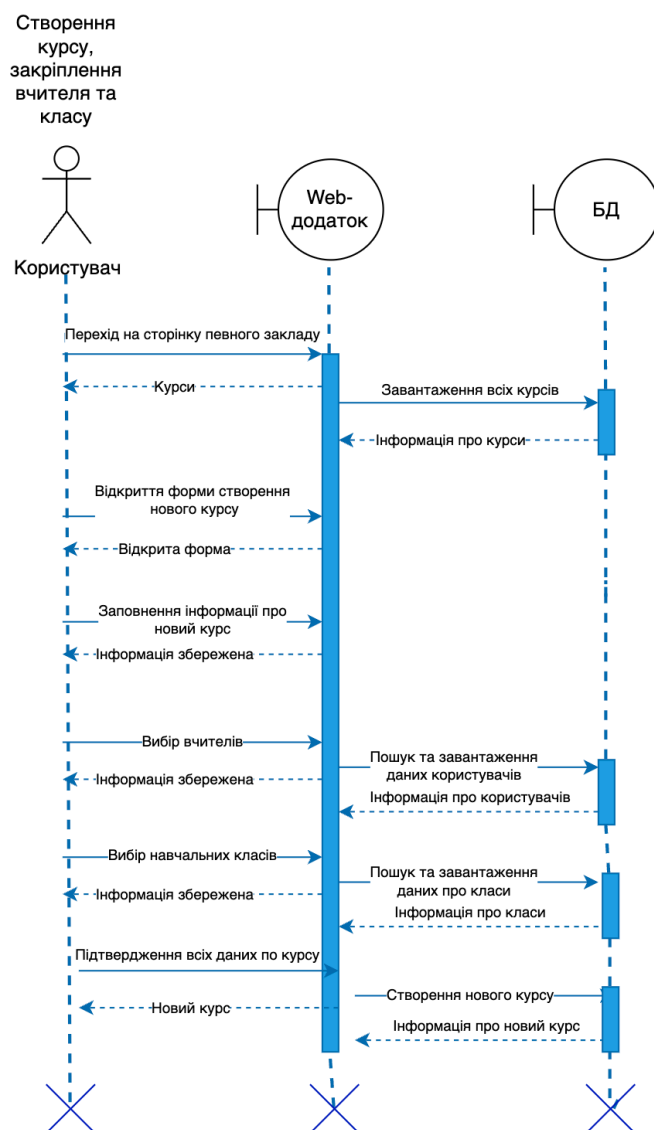
Рисунок 2.6 – Діаграма послідовності для ВВ «Створення курсу, закріплення вчителя та класу»
