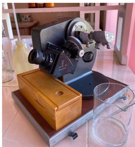
Рисунок 3.3 – Вимірювання показника заломлення: а) Рефрактометр ИРФ-22; б)
