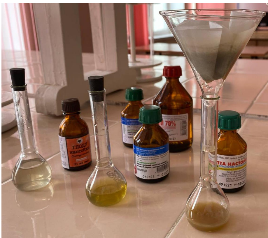
Рисунок 3.5 – Процес фільтрування настоянки після адсорбції
