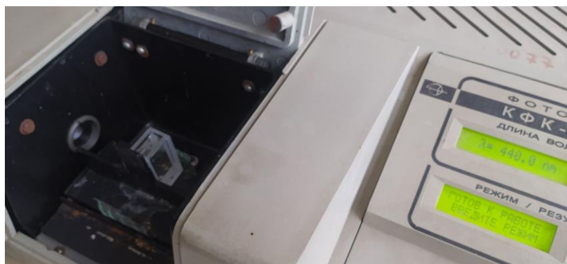
Рисунок 19 – Вимірювання оптичної густини за допомогою спектрофотометра КФК-3-01
