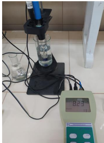
Рисунок 15 – Визначення рН розчинів рН-метром
