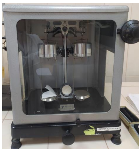
Рисунок 16 – Зважування фільтрів на аналітичних терезах (а) та розчинення добрив (б)
