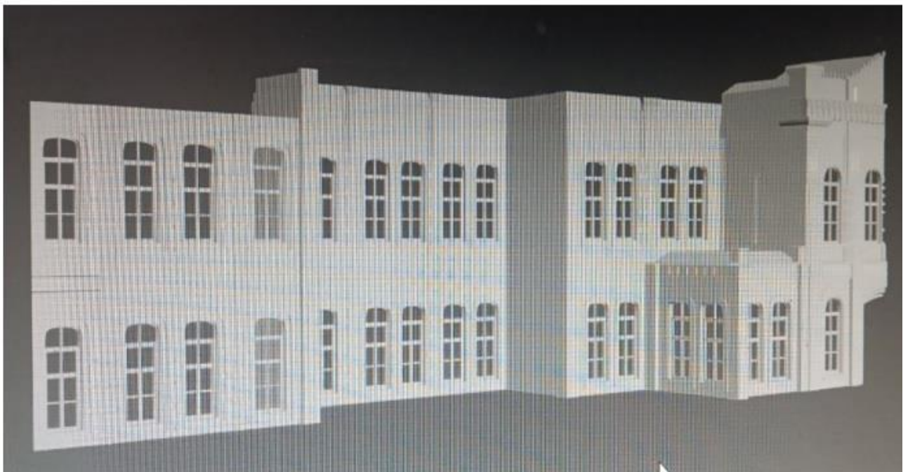
Рисунок 3.18 – Формування первинної сітки для створення вікон у будівлі НВК
