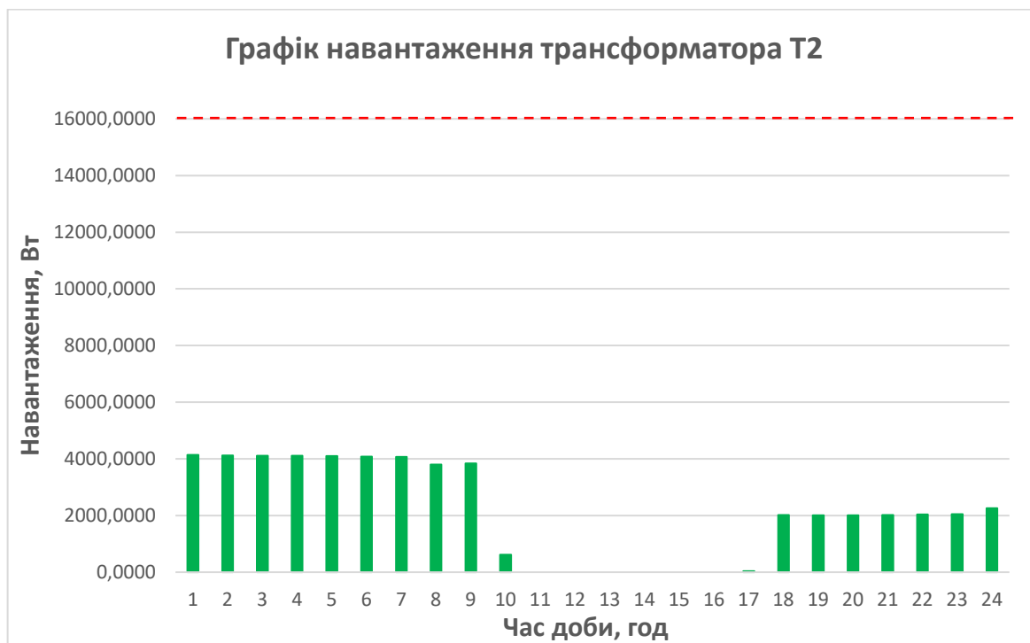
Рисунок 2.2 — Графік навантаження трансформатора Т2
