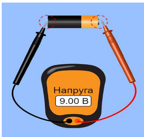
Рис. 2.8. Визначення напруги джерела живлення за допомогою демонстраційного вольтметра (адаптовано з URL: https://phet.colorado.edu/sims/html/circuit-construction-kit-ac/latest/circuit-construction-kit-ac_all.html?locale=uk )
