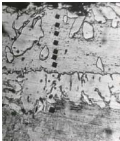
Рисунок 5.7 – Мікроструктура боридосиліцидних дифузійних покриттів. Насичувальна суміш (% мас.): 40(84B_4C+16Na_2B_4O_7)+60(95Si+5NH_4Cl)
