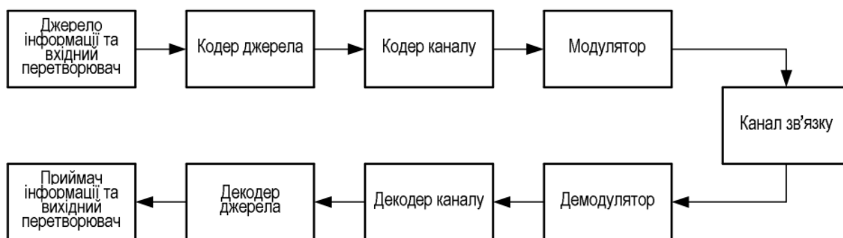
Рисунок 2.7 – Схема блоків для передачі та отримання сигналу через волоконно-оптичні лінії зв'язку [12].
