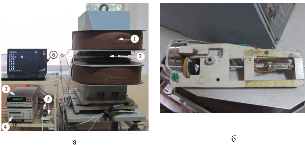
Рисунок 2.4 – Загальний зовнішній вигляд приладу для вимірювання магнітоопору магнітоопору (а) та тримача зразка (б):
