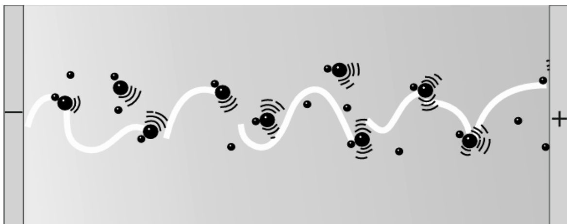
Рисунок 2.2 – Тепловий рух атомів і іонів у провіднику, що порушують порядок хвилеводу [16]
