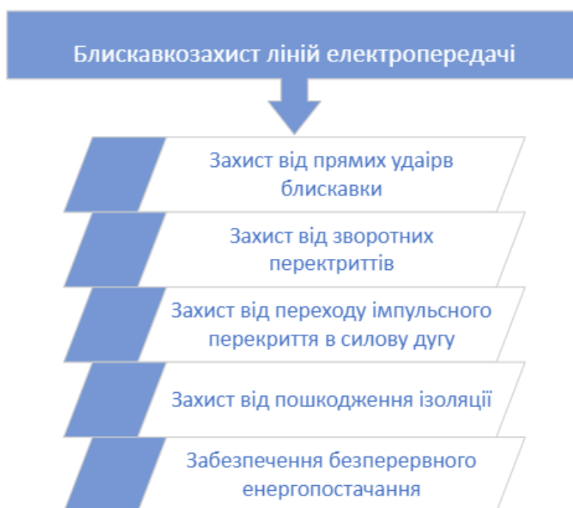
Рисунок 2.2 – Задачі блискавкозахисту ліній електропередачі
