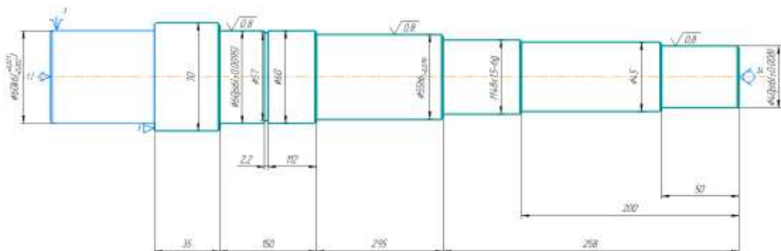
Рисунок 5.4 – Базування та закріплення заготовки на операції 020.
