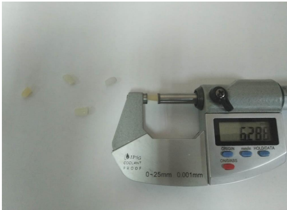
Рисунок 1 – Процес вимірювання довжини заполімеризованого зразка досліджуваного фотокомпозиту «Filtek Bulk Fill Flowable»
