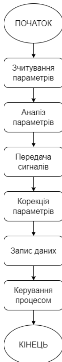
Рисунок 29 – Узагальнений алгоритм роботи системи управління виробництвом етилового харчового спирту
