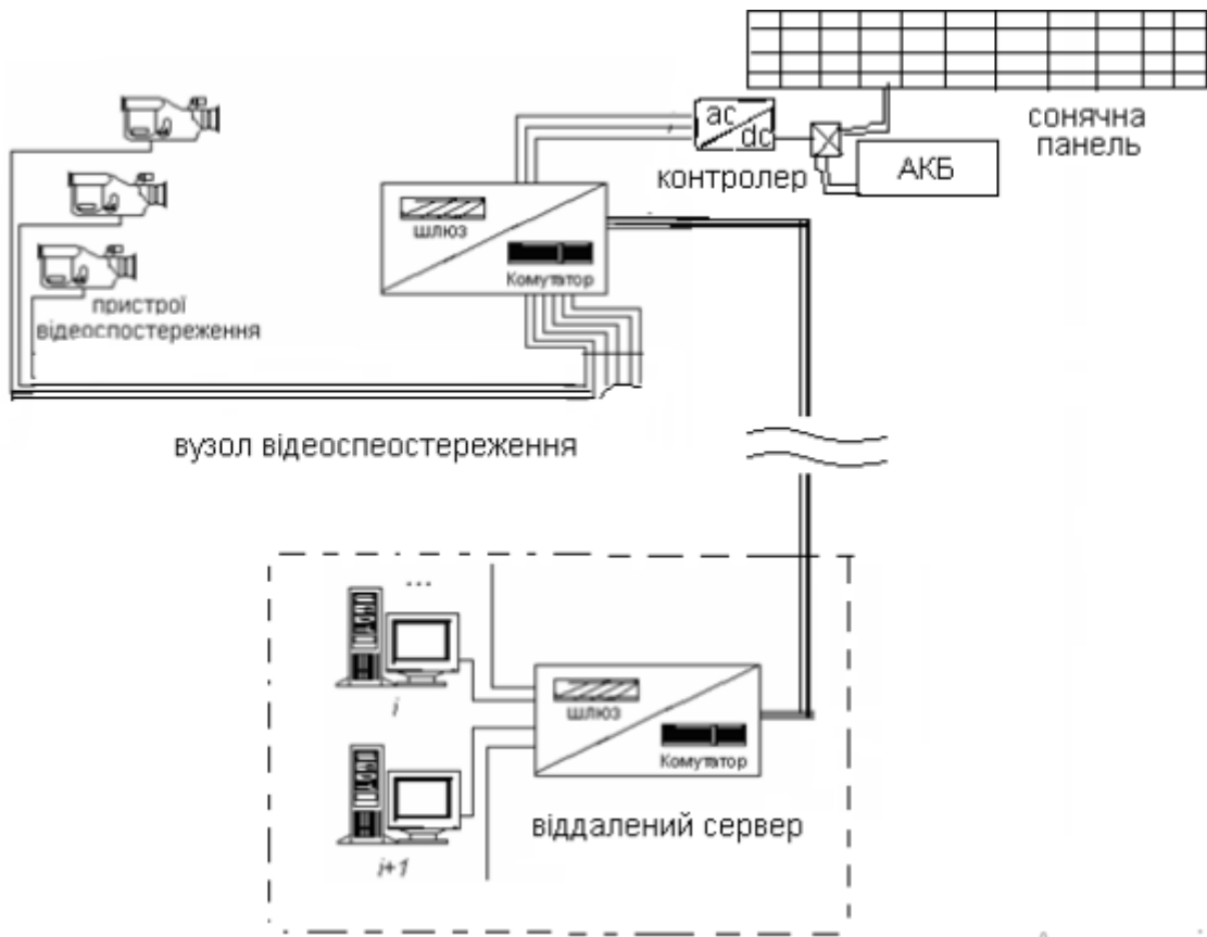
Рис. 3.1. Схема організації вузла відеоспостереження інформаційної мережі автономного живлення за допомогою комплексу ФЕП [21]
