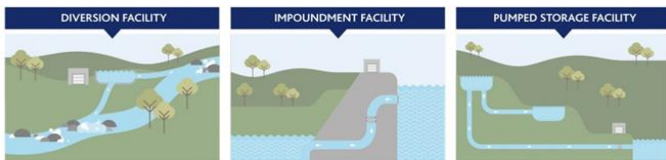
Рис. 1.7. Водовідвідна (а) водозбірна (б) насосно-акумулююча (в) гідроелектростанції [18]
