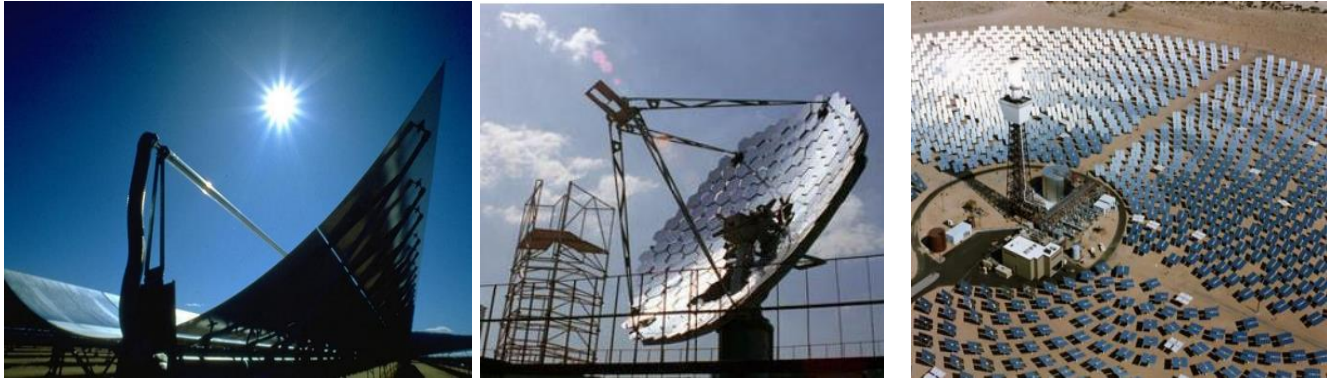
Рис. 1.9. Сонячні концентратори: параболоциліндричний (а), параболічний (б), баштова СЕС (в) [15]
