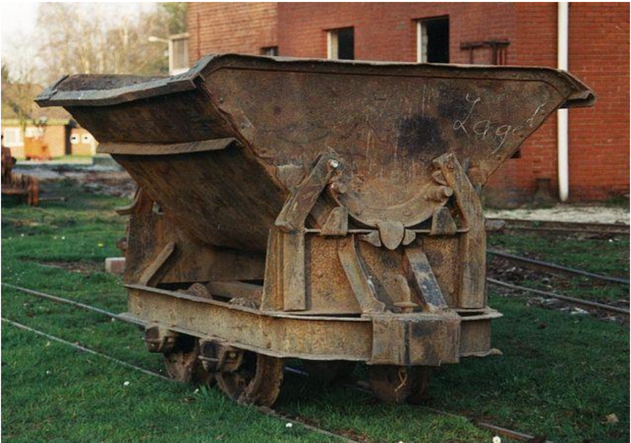
Рис. 1.2.1 Фрагмент вагонетки, яка слідує на бокове розвантаження
