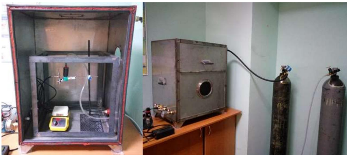
Рис. 1.5. Лабораторна установка спреї-піролізу з герметичною камерою [25]
