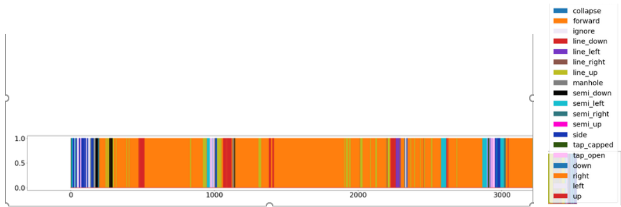
Рисунок 4.9 – Приклад результату покадрового розпізнавання контексту спостереження на даних відеоінспекції труб водовідведення
