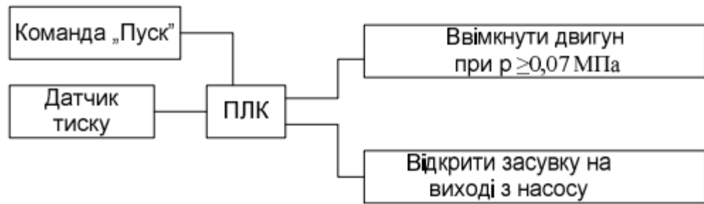
Малюнок 2.10 - Контур управління тиском рідкого мастила в кінці масляної лінії насоса
