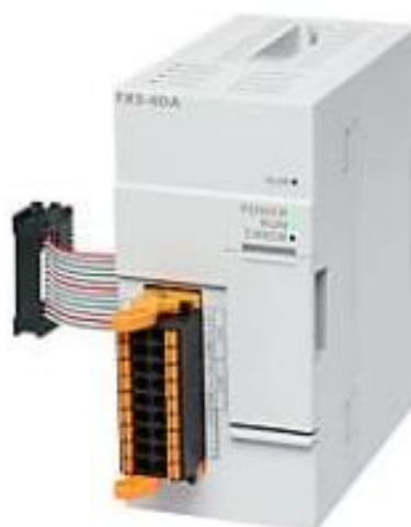
Рисунок 3.11 – Модуль Mitsubishi FX5-8AD [16]
