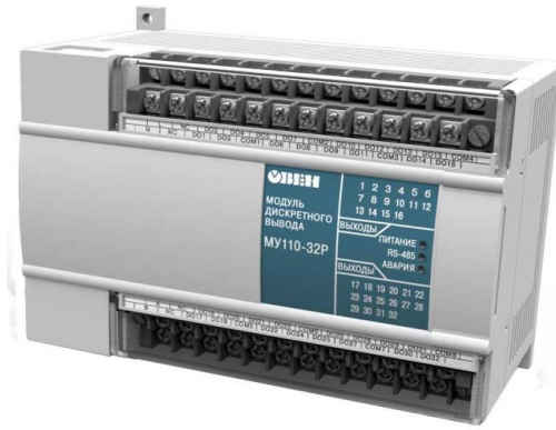
Рисунок 4.5 – Зовнішній вигляд ОВЕН МУ110-32Р
