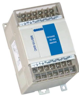
Рисунок 4.4 – Зовнішній вигляд ОВЕН МВ110-8А.
