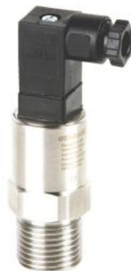
Рисунок 2.14 П'єзорезистивні давач тиску GENE BRE 8081E 250 1/4 G/M 4-20mA
