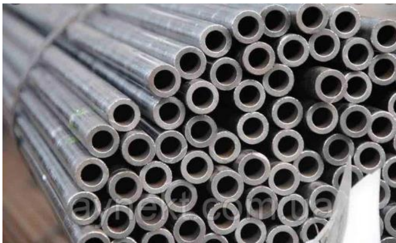
Рисунок 3.10 – Труба сталева Тр. 25х2.5
