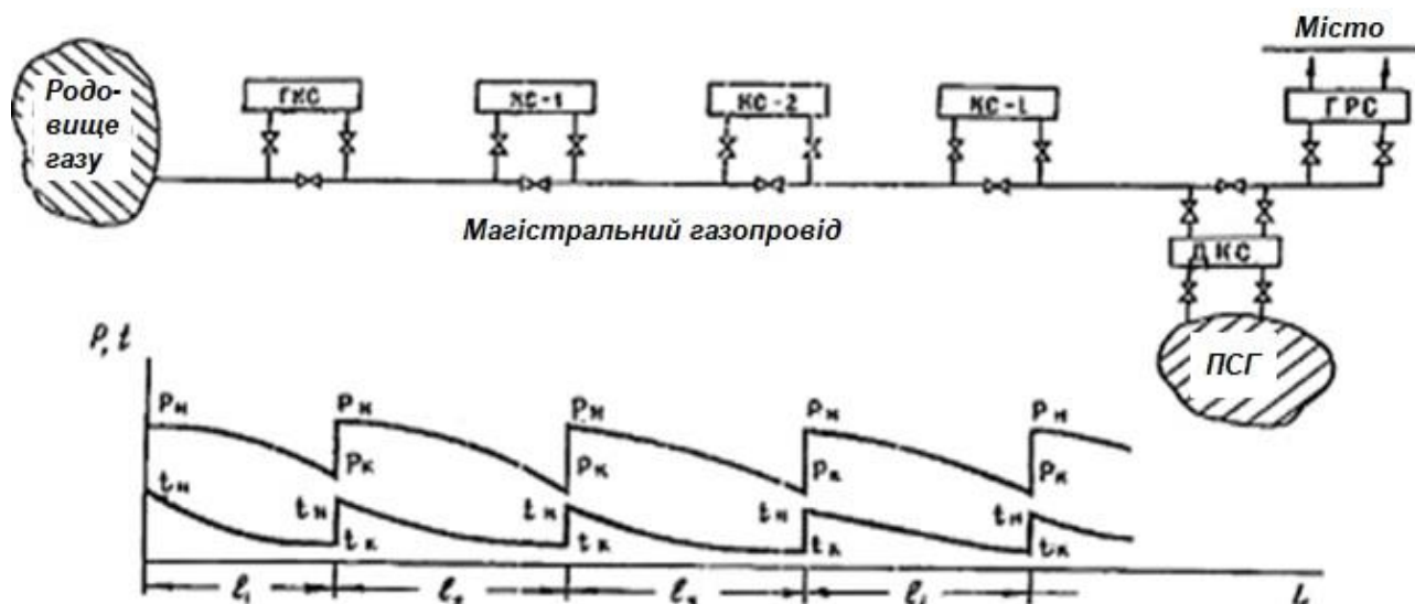
Рисунок 1.2 – Схема газопроводу та зміни тиску та температури газу вздовж траси
